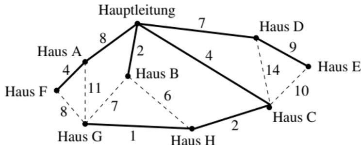
Verlegt die Firma genau diese Leitungen, so hat sie das neue Wohngebiet mit den geringstmöglichen Kosten ans Glasfasernetz angeschlossen.
