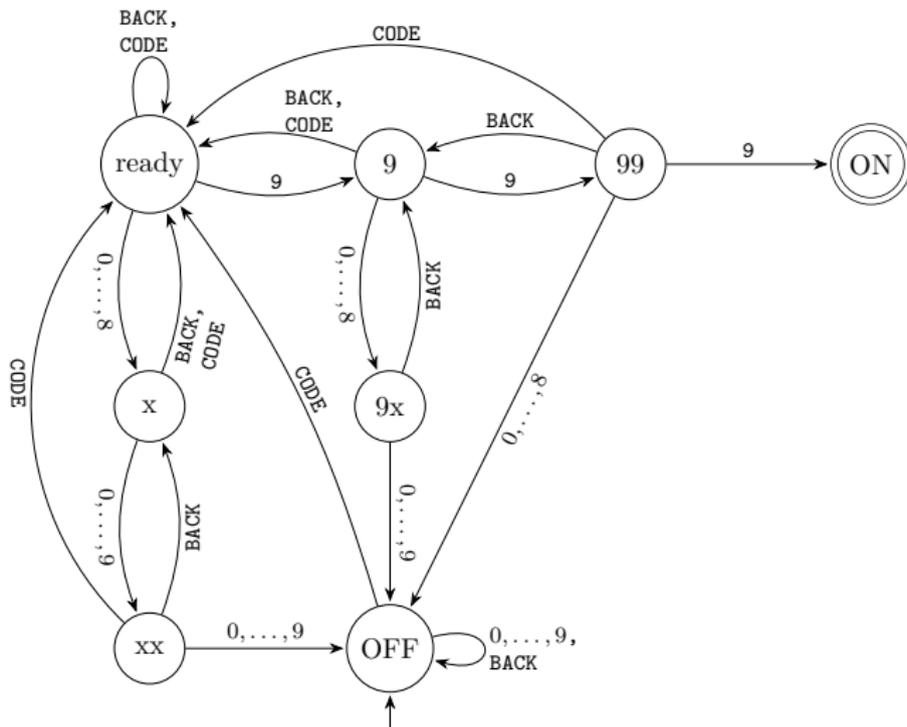
Der Automat „**akzeptiert**“ alle Folgen von Bedienoperationen, die vom Zustand „**OFF**“ in den Zustand „**ON**“ führen.
