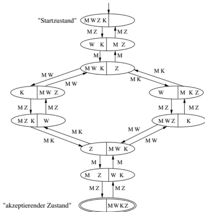
Dieser endliche Automat „akzeptiert“ genau diejenigen Folgen von einzelnen Flussüberquerungen, die vom Startzustand in den akzeptierenden Zustand führen.
